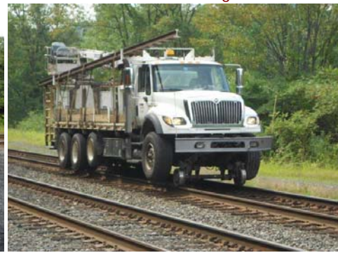
Travaux sur la voie ferrée avec ces engins hybrides rail-route
